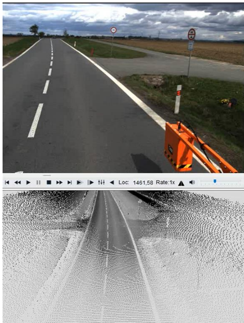
Obr. 4 - Stanovení hloubek konstrukce vozovky v místě svislé čáry je KS 4 v km 5,226 ve směru 1. Stanovené tloušťky jsou AHV 125 mm, recyklace 200 mm, ŠD 40 mm, vrstvy vozovky celkem 365 mm a upravená zemina 370 mm, celkem 735 mm. GPR stanovil tloušťky AHV správně, recyklaci a ŠD neodlišil (v podstatě stejný materiál, jen v recyklaci je přídavek práškového pojiva). Upravená zemina má hloubku o 120 mm vyšší. (Jelikož skutečné GPR měření o 7 m posunuto před laserové měření pak hloubka vrstvy odpovídá). Příkop je v hloubce 430 mm od hrany vozovky. Příčný řez dokládá pokles okraje vozovky.
