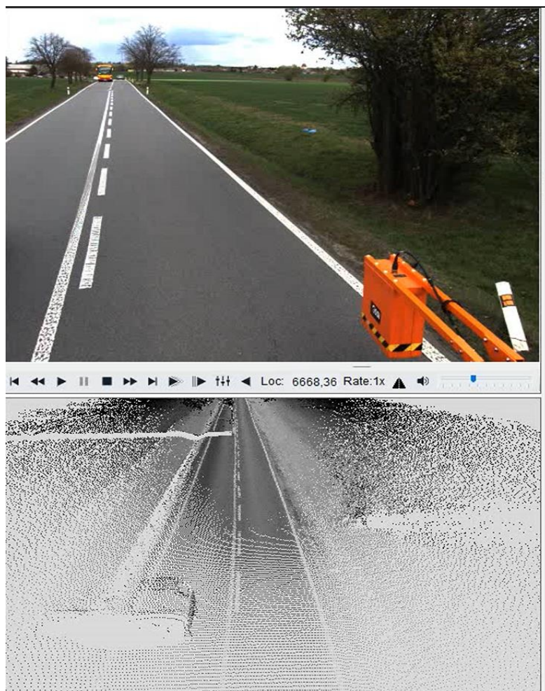
Obr.12 - Stanovení tloušťek konstrukce vozovky. V místě červené svislé čáry je kopaná sonda 15 v km 10,416 ve směru 1 se stanovením AHV 125 mm, recyklace 325 mm, ŠD v 100 mm (celkem 550 mm) a lomový kámen 380 mm (celkem 930 mm). Vyznačené tloušťky podle GPR odpovídají kopané sondě, ŠD je spojena s lomovým kamenem.
